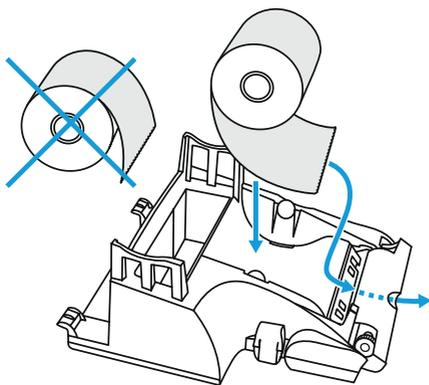
4. 將打印機紙卷的末端穿過打印墨嘴。
