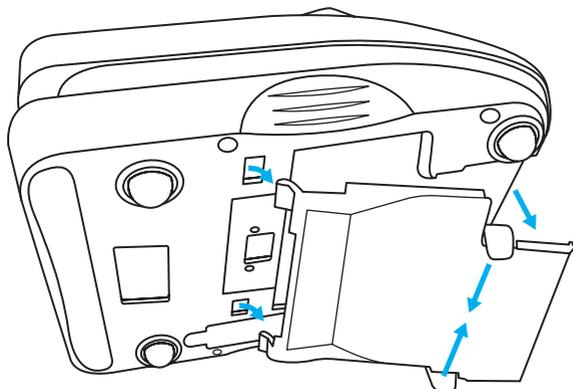
3. Schieben Sie nun behutsam die beiden Haltevorrichtungen in den Boden des Zählgerätes.
